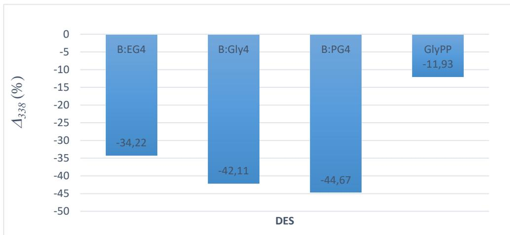
Slika 19. Grafovi s relativnim apsorbancijama ( $A_{338Rel}$ ) (a) i odstupanjima ( $\Delta_{338}$ ) od početne apsorbancije (b) uzoraka s betainom izmjenjenih pri 338 nm nakon inkubacije na 25 °C tijekom 14 dana. Rezultati su prikazani kao srednja vrijednost ( $n=2$ ).
