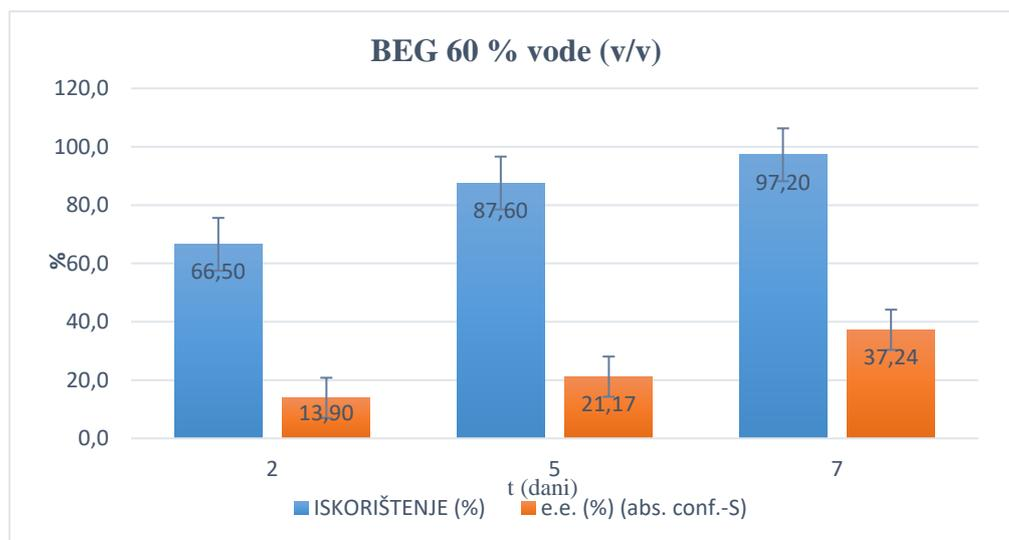
Slika 26. Enantiomerni višak (*ee*) te iskorištenje ( $\eta$ ) redukcije 2-klor-1-(3,4-difluoro-fenil)etanona katalizirane cijelim stanicama pekarskog kvasca nakon 2, 5 i 7 dana u a) vodi, b) puferu, c) eutektičkom otapalu BEG s 0 % vode, d) eutektičkom otapalu BEG s 20 % vode, e) eutektičkom otapalu BEG sa 60 % vode. Reakcijski uvjeti: 10  $\mu$ L matične otopine 2-klor-1-(3,4-difluoro-fenil)etanona ( $\gamma = 2 \text{ mg mL}^{-1}$ ), 0,5 mg kvasca otopljenog u otapalu te 1,5 mL otapala.
