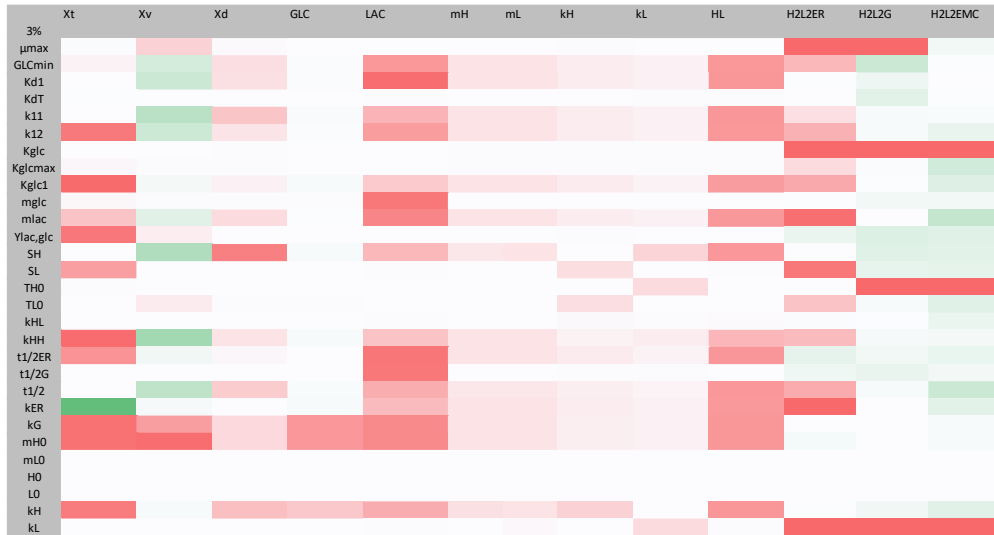
Slika 16. Grafički prikaz lokalne osjetljivosti koncentracija metabolita na povećanje vrijednosti kinetičkih parametara za 3 % u hiperosmotskim uvjetima
