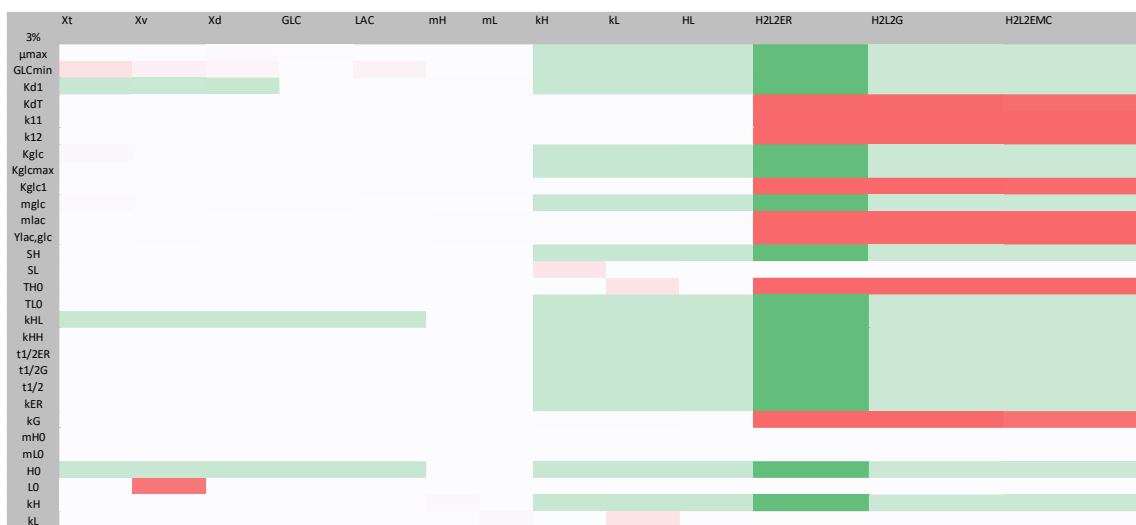
Slika 14. Grafički prikaz lokalne osjetljivosti koncentracija metabolita na povećanje vrijednosti kinetičkih parametara za 3 % u normalnim uvjetima
