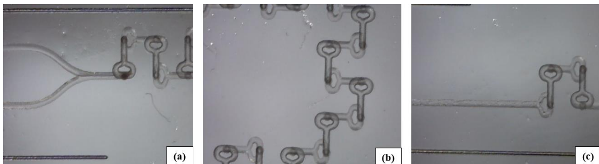
Slika 6. Profili strujanja u mikrokanalu s mikromiješalima u izvedbi viseće kapi (pri protoku uljne faze od q = 50 \mu\text{L min}^{-1} i protoku vodene faze od q = 150 \mu\text{L min}^{-1} ). (a) ulazni dio mikrokanala, (b) središnji dio mikrokanala i (c) izlazni dio mikrokanala.
