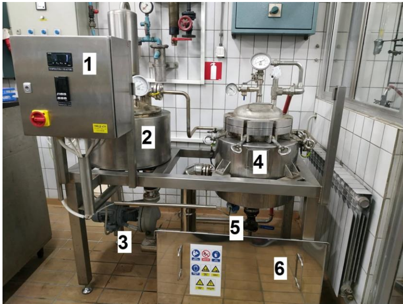
Slika 3. Visokotlačni bioreaktor (1 - kontrolna jedinica; 2 - posuda s grijačima i termičkim uljem; 3 - pumpa, 4 - reaktor za predobradu sirovine; 5 - ventil za ispuštanje tekućeg dijela; 6 - zaštitna jedinica) (Vrdoljak, 2019)
