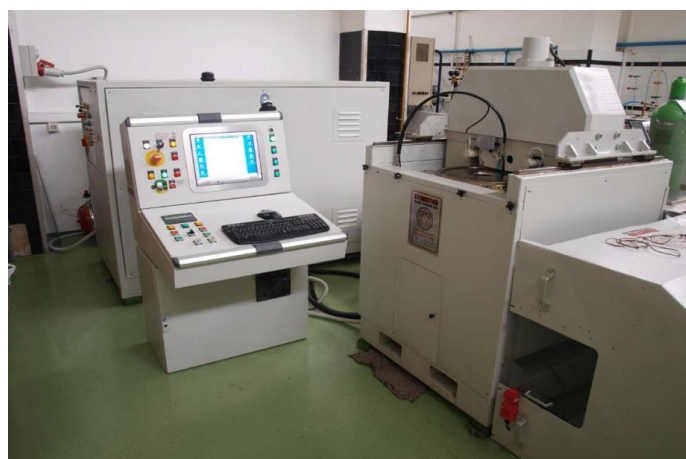
Slika 5. Uređaj za obradu VHT-om STANSED FLUID POWER (Velika Britanija) (Burcar, 2019)
