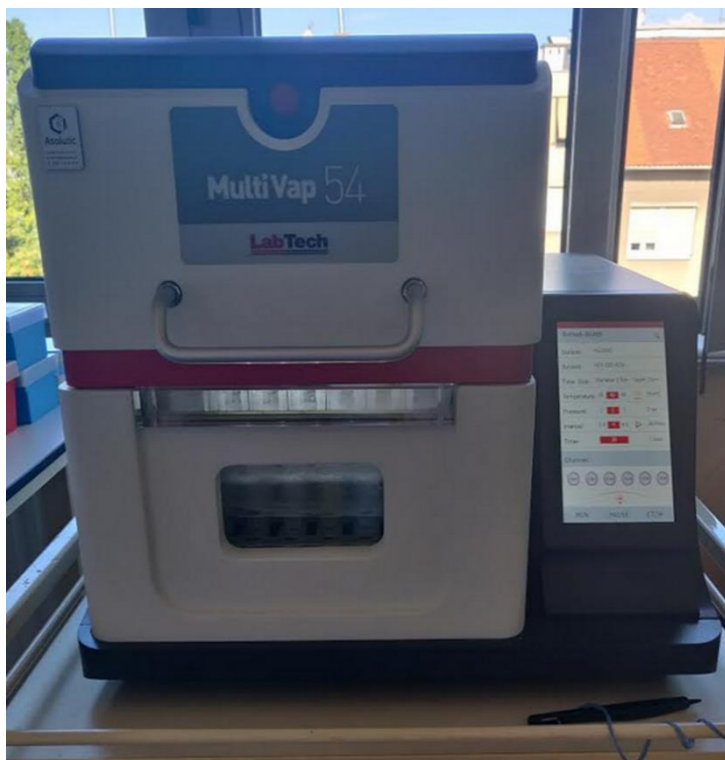
Slika 3. Uparivač MultiVap 54 (Vlastita fotografija).
