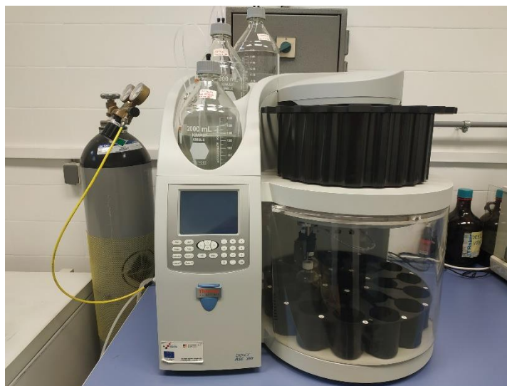
Slika 9. Ekstraktor ThermoScientific™ Dionex™ ASE™ 350 (vlastita fotografija, 2019)
