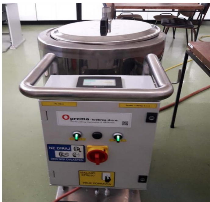
Slika 9. Šaržni pasterizator PS 100 (PBF, 2020)
