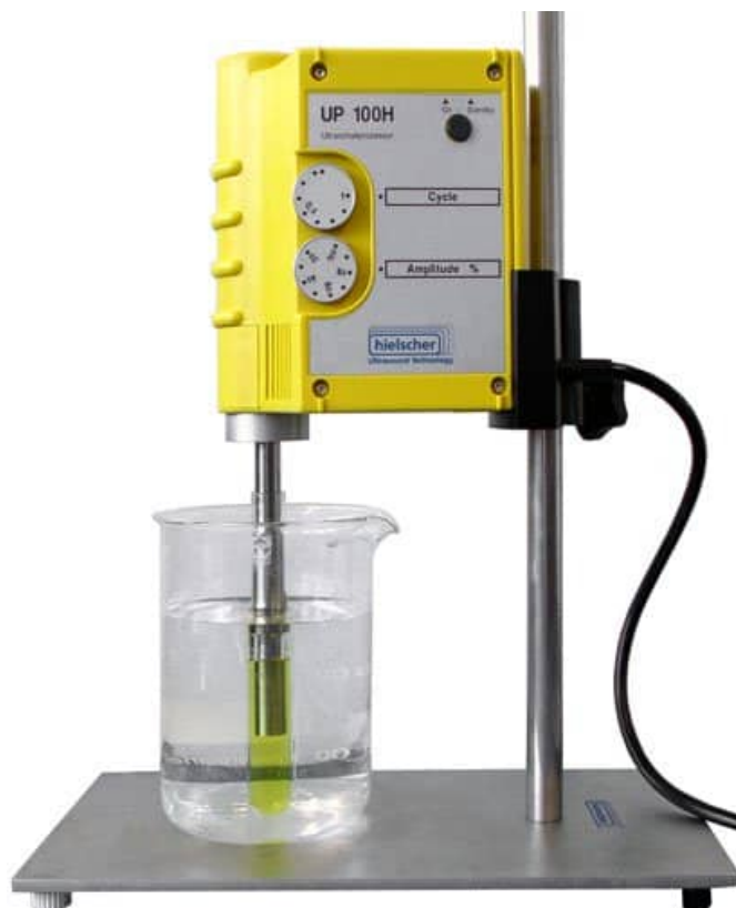
Slika 7. Ultrazvuk visokog intenziteta „dr. Hielscher UP 100H“, Njemačka (Hielscher, 2020)
