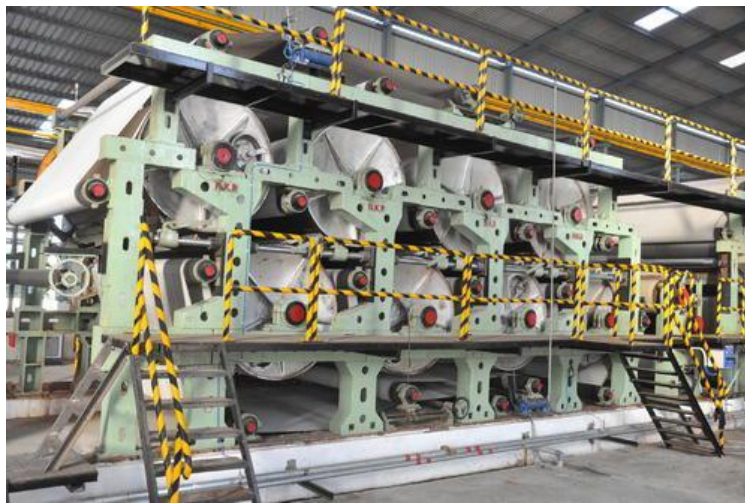
Slika 7. Sekcija za sušenje papirnog stroja (Anonymus 4, 2020)
