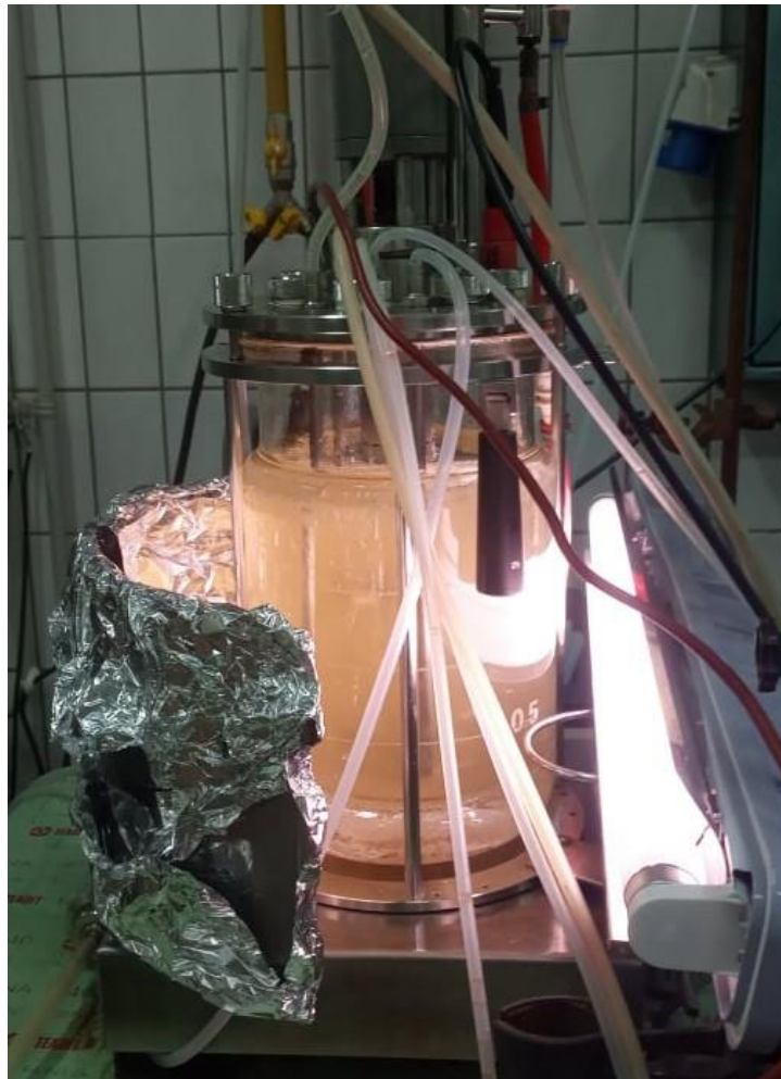
Slika 9. Laboratorijski bioreaktor s vanjskim umjetnim izvorom toplo-bijele svjetlosti
