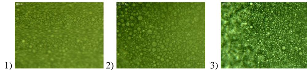
**Slika 21.** Mikroskopski prikaz kapljica emulzije ulje u vodenom ekstraktu mente, s dodatkom emulgatora, pripremane pri optimalnim uvjetima – 1) PEG1500 2) PEG6000 3) PEG20000
