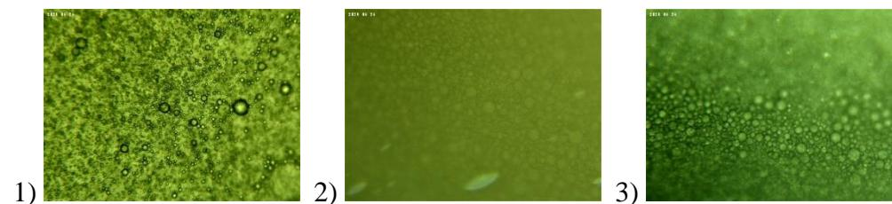
**Slika 19.** Mikroskopski prikaz kapljica emulzije ulje u vodenom ekstraktu majčine dušice, s dodatkom emulgatora, pripremane pri optimalnim uvjetima – 1) PEG1500 2) PEG6000 3) PEG20000
