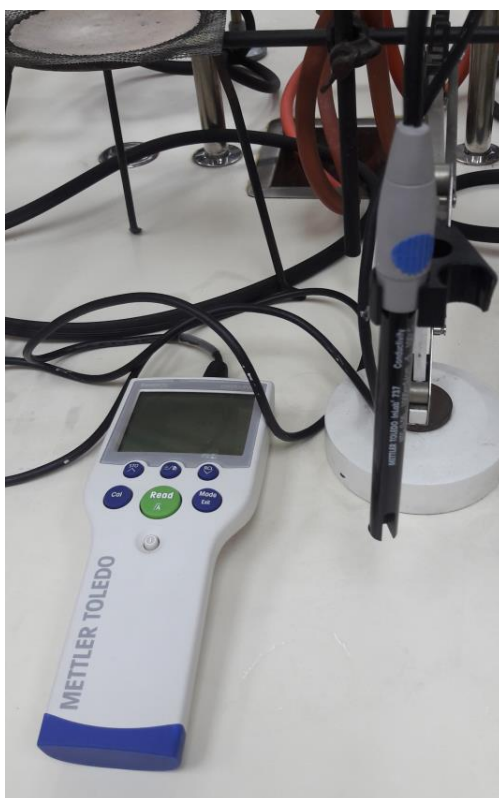
Slika 3. Mettler Toledo konduktometar s elektrodom (vlastita fotografija)
