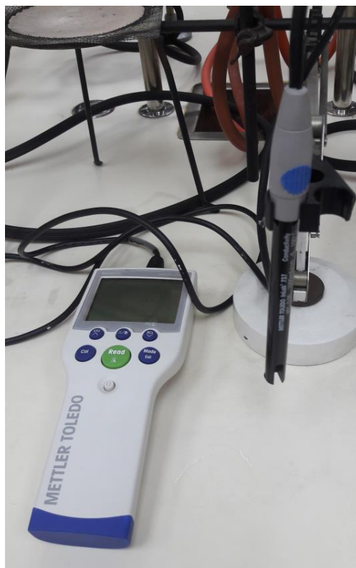
Slika 3. Mettler Toledo konduktometar s elektrodom (vlastita fotografija)
