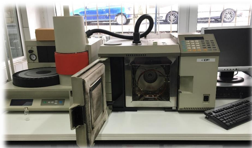
Slika 6. Plinski kromatogram „Perkin Elmer Autosystem XL-GC (Perkin Elmer, SAD) uz pripadajući sustav za uzorkovanje „Perkin Elmer Headspace Sampler 40XL“ (Perkin Elmer, SAD)
