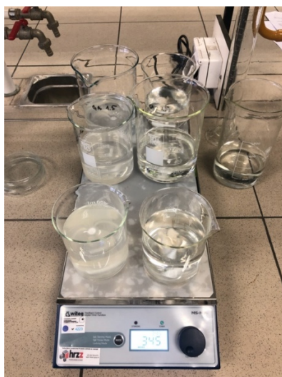
Slika 9. Miješanje otopina za pripremu jestivih filmove (vlastita fotografija)
