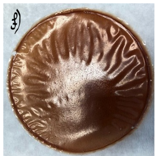
Slika 4. Fotografije filmova pripremljenih otapanjem 2, 2,5 i 3 g kitozana sa i bez dodatka ekstrakta sjemenki grožđa (GSE)
