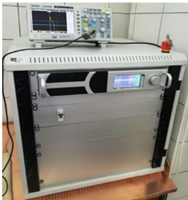
Slika 7. Plazma generator (Impel grupa, Zagreb, Hrvatska)
