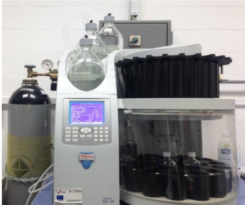
Slika 6. Ekstraktor ASE™ 350 (vlastita fotografija)
