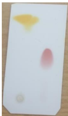
Slika 35. Primjer pločice presvučene silikagelom nakon provedene tankoslojne kromatografije
