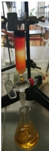
Slika 36. Primjer kromatografske kolone na stupcu od silika gela pri pročišćavanju N1 -ferocenoil uracilnih derivata
