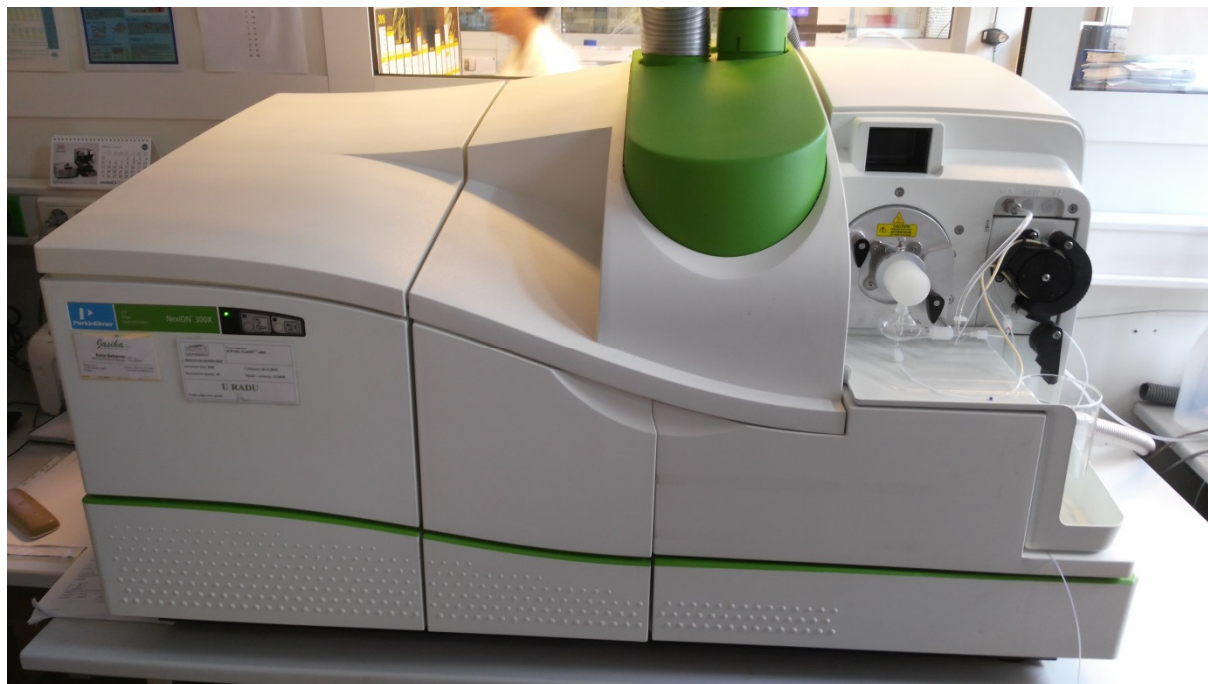
Slika 6. Maseni spektrometar s induktivno-spregnutom plazmom (ICP-MS) PerkinElmer NexION 300x (vlastita fotografija).
