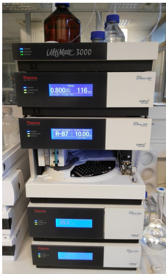
Slika 4. Visokodjelotvorni tekućinski kromatograf (HPLC) ThermoUltimate 3000 (vlastita fotografija).
