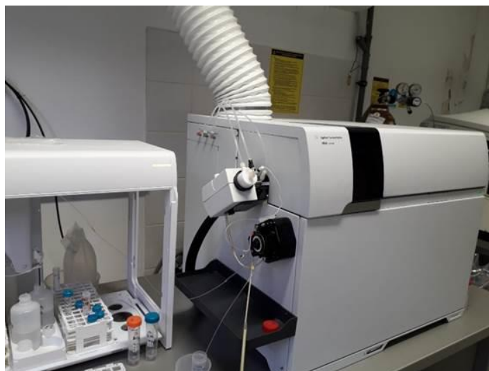
Slika 11. Uređaj induktivno spregnute plazme s masenim detektorom (ICP-MS 7800) proizvođača Agilent (NZJZ dr. Andrija Štampar)
