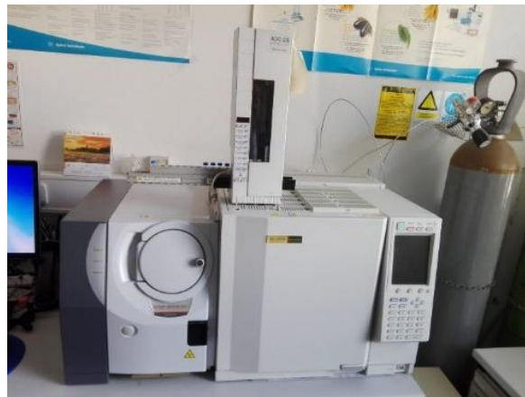
Slika 15. Uređaj za plinsku kromatografiju s masenom spektrometrijom (GC-MS) QP 2010 Plus (vlastita fotografija)
