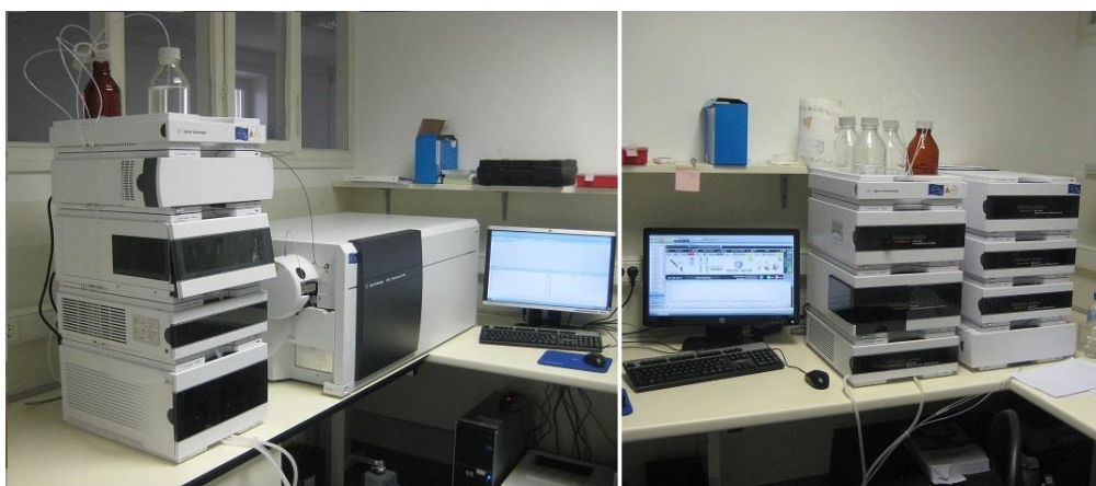
Slika 14. Uređaji za ultradjelotvornu tekućinsku kromatografiju (UPLC) uz MS/MS detekciju i visoko djelotvornu tekućinsku kromatografiju (HPLC) uz UV/VIS PDA detekciju (vlastita fotografija)
