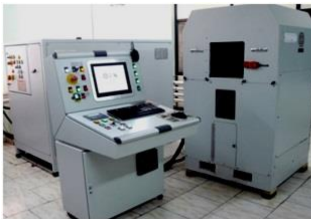
Slika 21. Uređaj za ekstrakciju potpomognutu visokim hidrostatskim tlakom (Anonymous, 2017)
