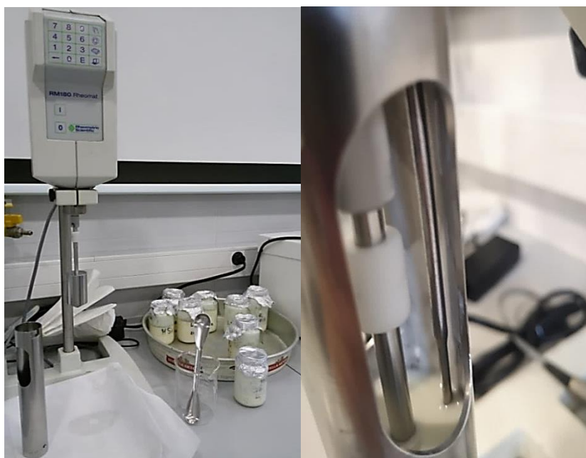
Slika 13. Reometar korišten za određivanje viskoznosti u uzorcima jogurta: lijevo – priprema za mjerenje, desno – tijekom mjerenja (vlastita fotografija)
