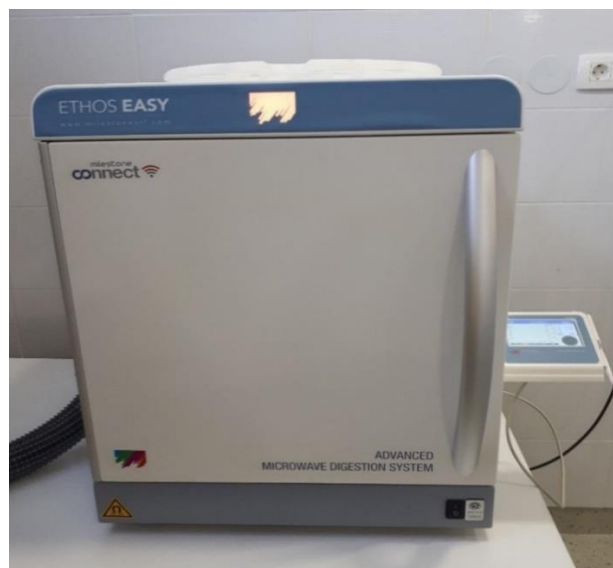
Slika 4. Mikrovalni reaktor, Ethos Easy (Milestone, Italija) (fotografija: Vrančić, 2020)
