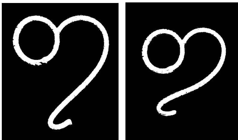
Slika 21. Binarna fotografija 3D tiskanog oblika nakon tiskanja (lijevo) i nakon pečenja (desno)
