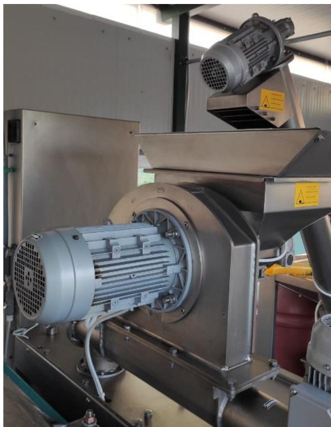
Slika 11 - Dio Olimio profy 200 stroja u kojem se nalazi mlin čekićar (izvor: vlastita fotografija)
