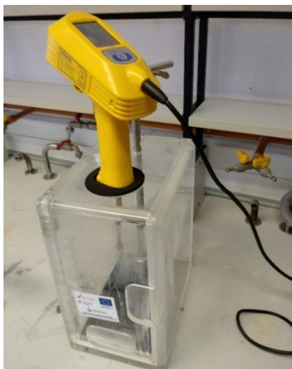
Slika 4. Ultrazvučni postav sa sondom (Vlastita fotografija)
