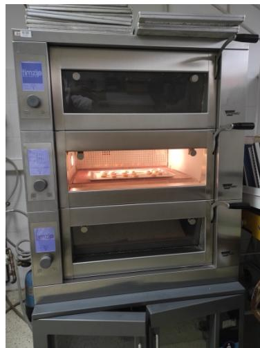
Slika 6. Pećnica (EB 064-320 IS 600, Wiesheu, Njemačka)
