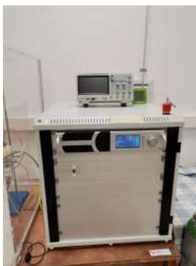
Slika 5. HVED generator (Impel grupa, Zagreb, Hrvatska)
