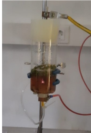
Slika 6. Visokonaponsko električno pražnjenje u suspenziji s origanom
