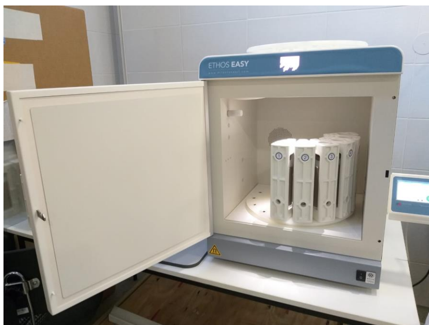
Slika 1. Mikrovalni ekstraktor - Ethos EASY – Advanced Microwave Digestion System (vlastita fotografija)
