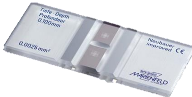
Slika 4. Neubauerova komorica za brojanje stanica
