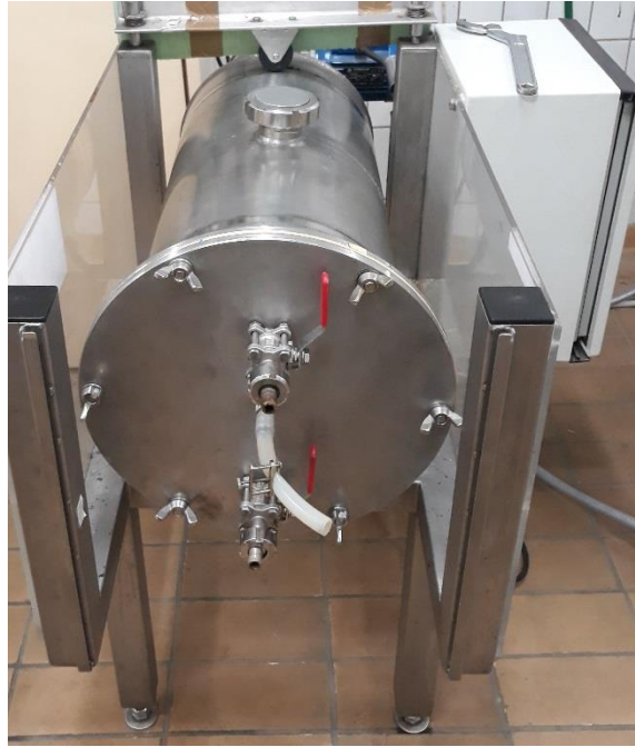
Slika 6. Horizontalni rotirajući cijevni bioreaktor (HRCB)
