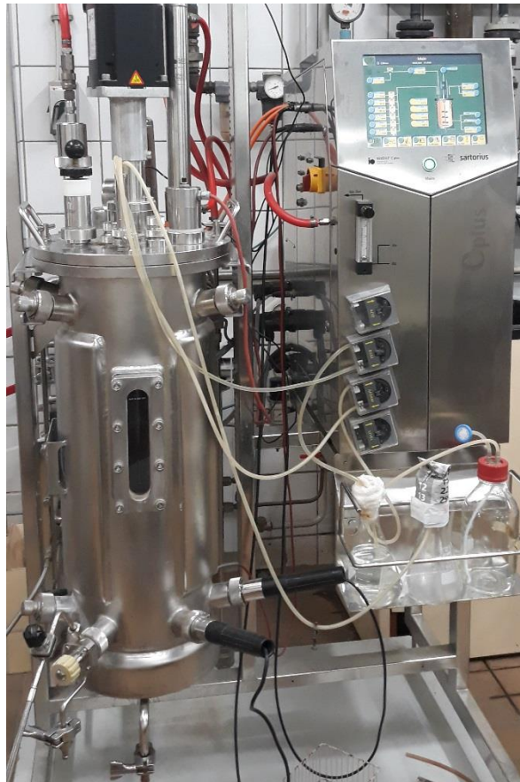
Slika 5. Bioreaktor s miješalom Biostat Cplus s regulacijom pH i temperature
