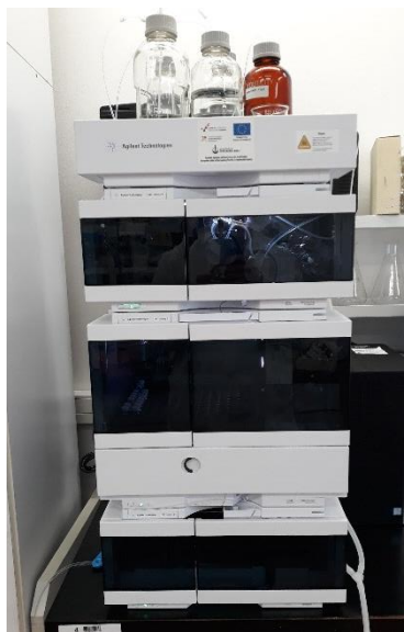
Slika 4. Uređaj za tekućinsku kromatografiju ultra djelotvornosti (UPLC)
