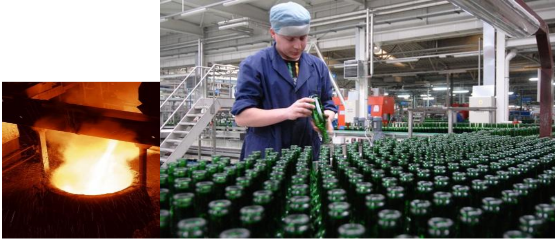
Slika 1: Taljenje, fomiranje i kontrola boca ( www.veleri.hr ).
