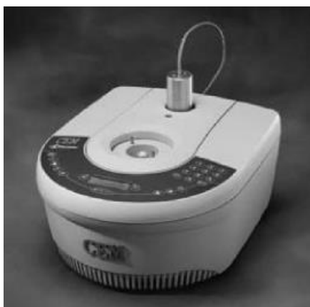
Slika 16. Jednofunkcijski mikrovalni reaktor (Zrinski i Eckert-Maksić, 2005)
