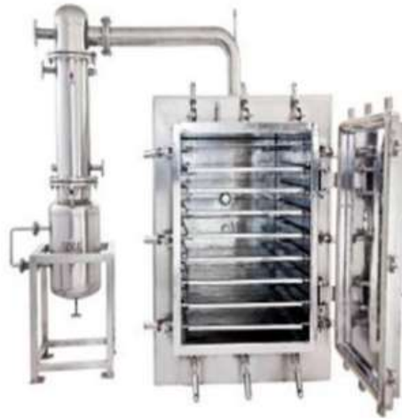
Slika 10. Pločasta vakuum sušara (Anonymous 6, 2021)
