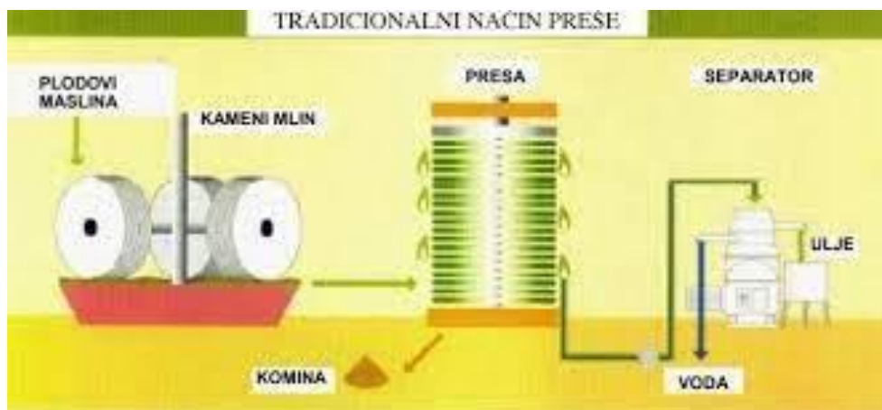
Slika 8. Tehnološki proces izdvajanja ulja prešanjem (Gugić i Ordulj, 2006)
