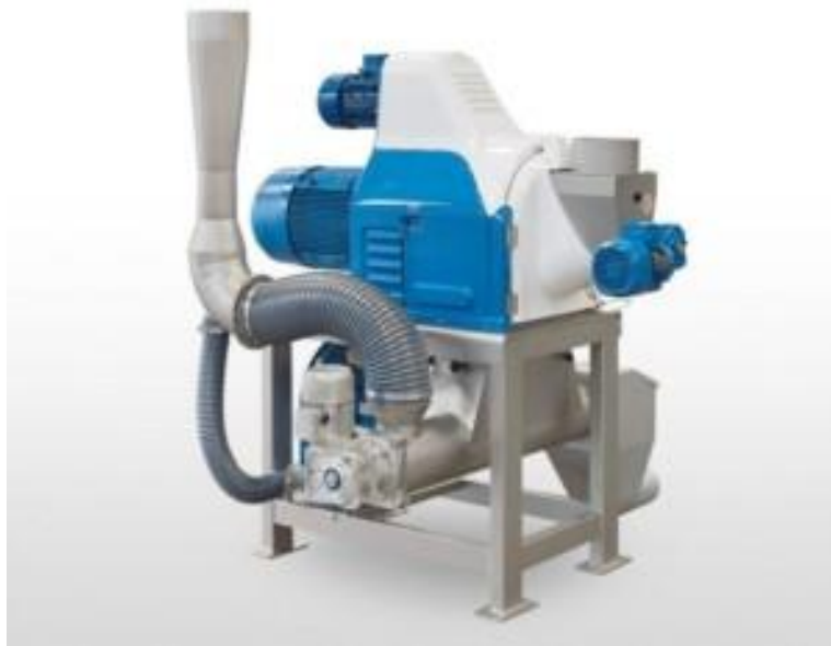
Slika 7. Metalni mlin – čekičar (Com-ing trade, 2021)
