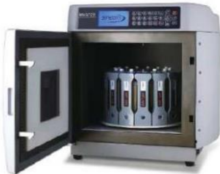
Slika 15. Zatvoreni sustav za ekstrakciju potpomognutu mikrovalovima (Jagić, 2016)
