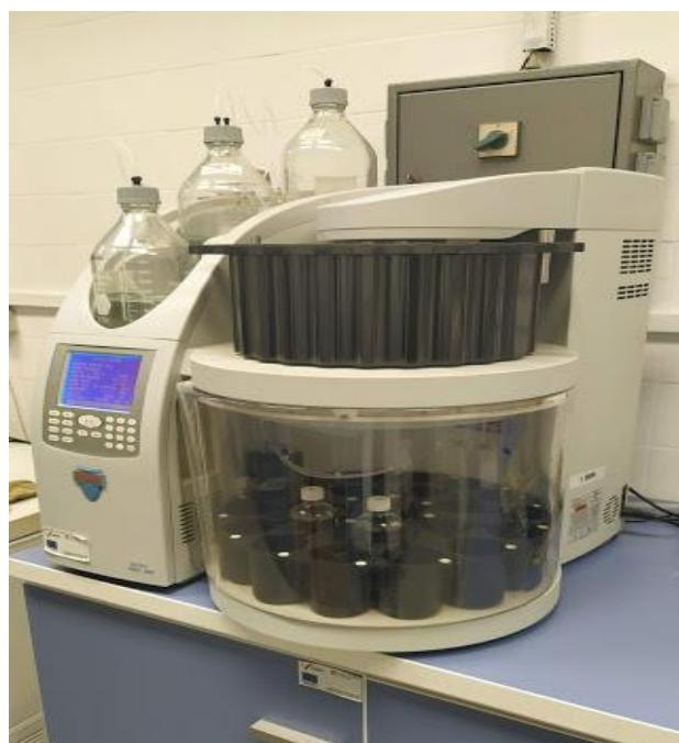
**Slika 5.** ASE 350<sup>TM</sup> ekstraktor (vlastita fotografija)
