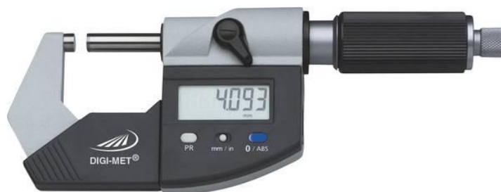
Slika 6. Digitalni mikrometar Helios Preisser DIGI-MET, Njemačka (Anonymous 1)
