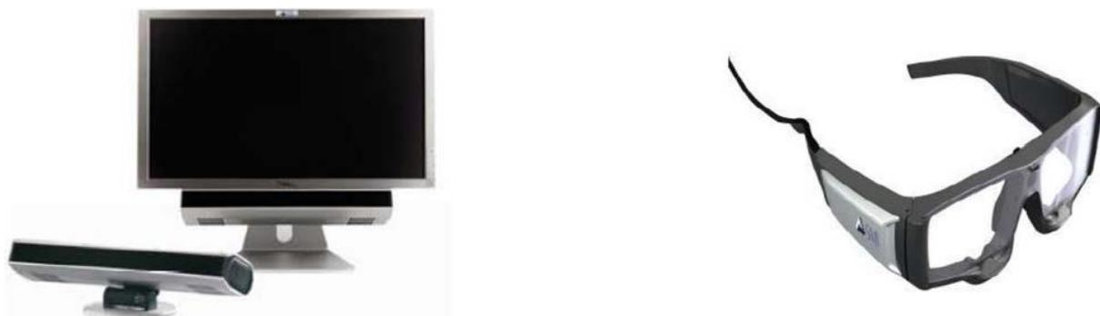
Slika 3. Statični eye tracker i laboratorijsko ispitivanje (lijevo), uređaj za daljinsko snimanje (desno) (Stasi i sur., 2018)
