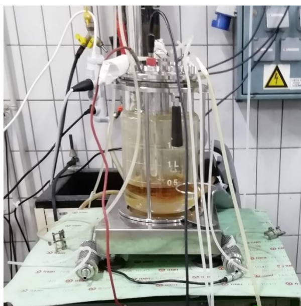
Slika 5. Bioreaktor s mješalom (B. Braun Biotech International, Berlin, Njemačka) (vlastita fotografija)
