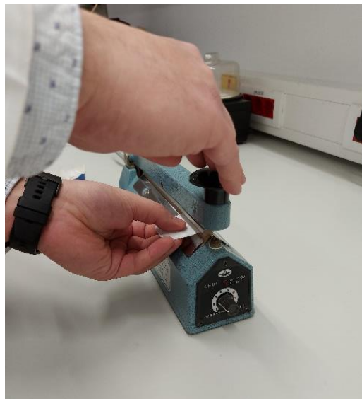
Slika 12. Vrećice s izvaganim uzorkom (a). Prikaz zavarivanja vrećica na uređaju za zavarivanje (b) (Vlastite fotografije)
