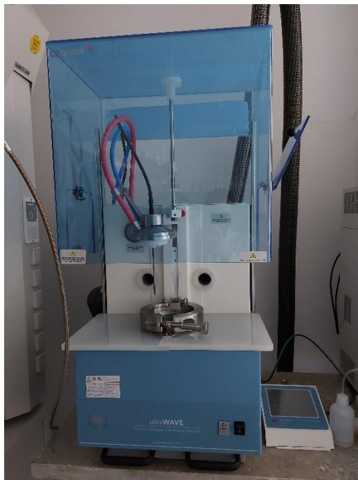
Slika 10. Mikrovalna pećnica korištena za razgradnju uzorka (Vlastita fotografija)
