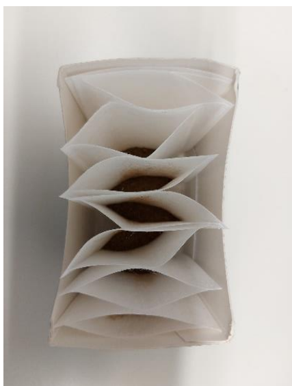
Slika 12. Vrećice s izvaganim uzorkom (a). Prikaz zavarivanja vrećica na uređaju za zavarivanje (b) (Vlastite fotografije)
