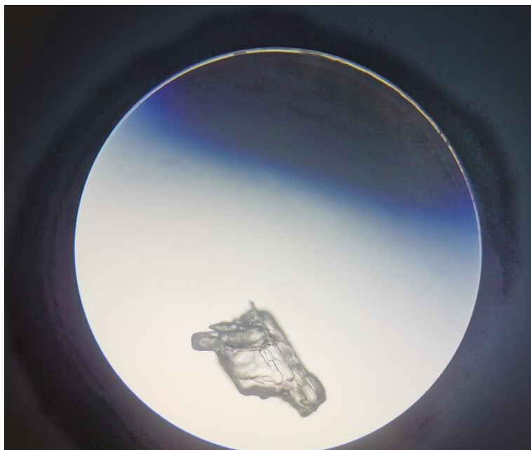
Slika 7. Pojava kristala u uzorku niskotemperaturnog eutektičkog otapala prilikom otapanja halogeniranog acetofenona.
