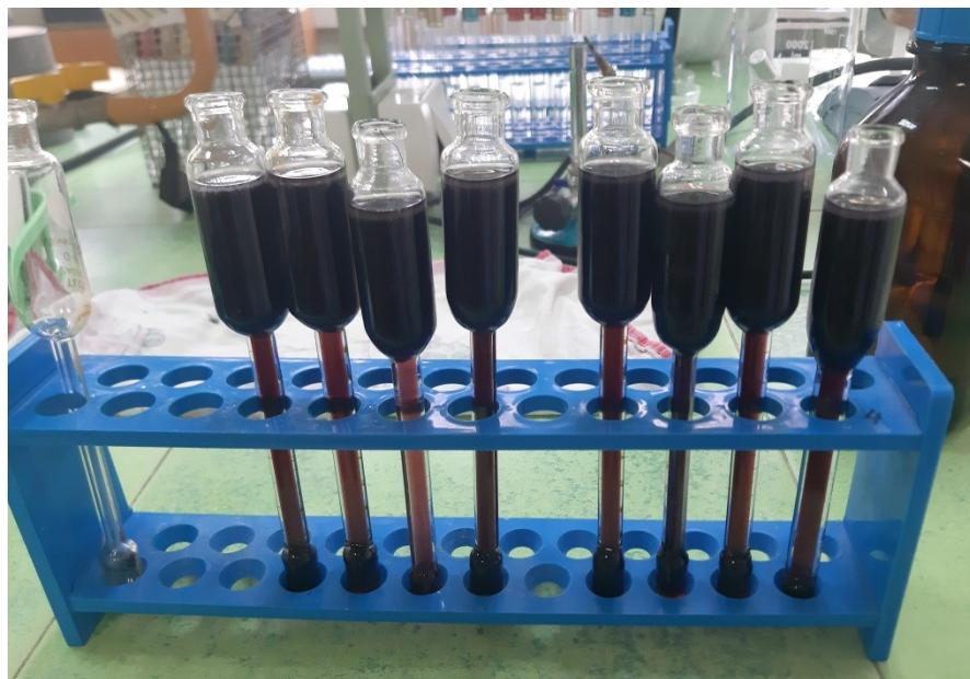
Slika 8. Određivanje mliječne masti (vlastita fotografija)
