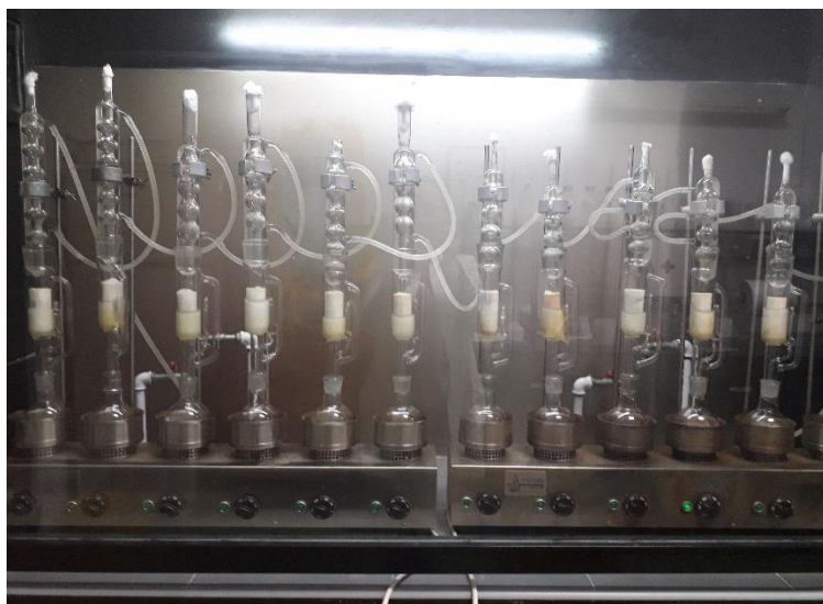
Slika 9. Aparatura po Soxhletu (vlastita fotografija)
