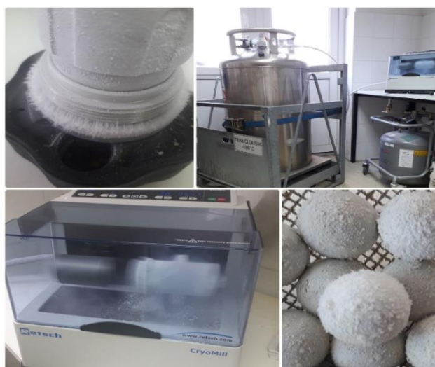
Slika 5. Kriomlin, spremnik s tekućim dušikom, kuglice i spremnik za uzorak (vlastita fotografija)
