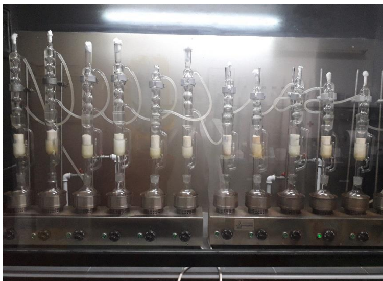
Slika 9. Aparatura po Soxhletu (vlastita fotografija)
