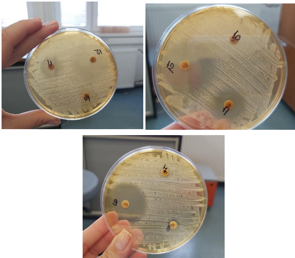
Slika 2. Zone inhibicije vidljive nakon prekononoćne inkubacije pri 37°C (vlastita fotografija).
